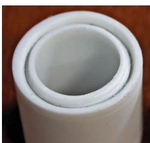
Вид отторцованной трубы PP-ALUX
